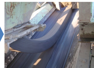
高含水比粘性土供給状況
