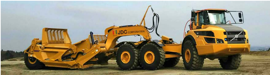
▲2018年に導入したスクレーパと牽引車 従来機比、高速走行を実現（時速15km→45km）
